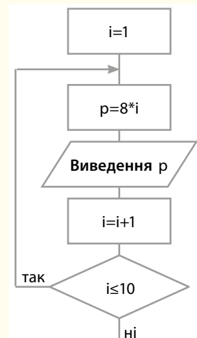
Рис. 2. Фрагмент графічної схеми циклічного алгоритму
