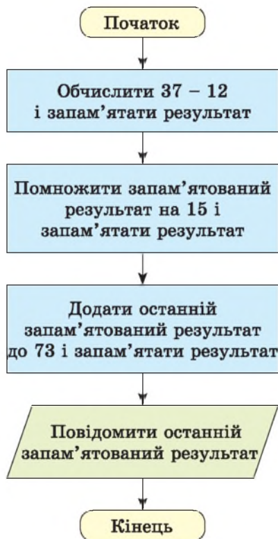
Рис. 1.20. Блок-схема алгоритму обчислення значення виразу 73 + (37 - 12) \cdot 15
