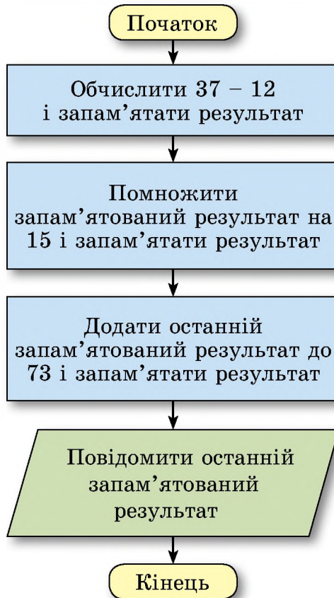
Мал. 4.15. Блок-схема алгоритму обчислення значення виразу 73 + (37 - 12) \cdot 15
