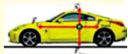
Рис. 139. Сили, що діють на автомобіль
