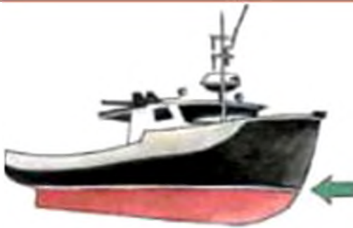
Рис. 196. Найбільш допустимий осадка судна — ватерлінія
