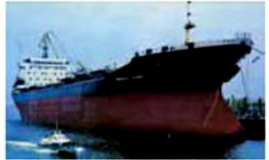
Рис. 197. Сухогруз «Микола Бажан» Чорноморського пароплавства (порт приписки Одеса), побудований на Миколаївському суднобудівальному заводі «Океан». Довжина судна — 215,4 м, осадка 12,3 м, водотоннажність 50150 т
