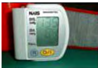
Рис. 186. Манометр для вимірювання артеріального тиску
