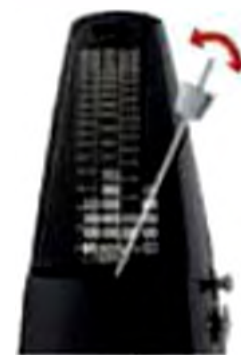
Рис. 73. Приклади фізичних маятників: а) лінійка, що коливається навколо закріпленої осі; б) ніжка із тягарцем у метрономі
