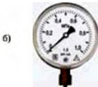
Рис. 185. Металевий манометр: а) схема будови манометра; б) технічний манометр для вимірювання великих тисків
