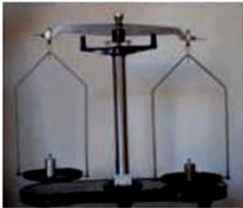
Рис. 96. Дослід підтверджує, що при однакових об'ємах маси тіл залежать від виду речовин, з яких вони виготовлені
