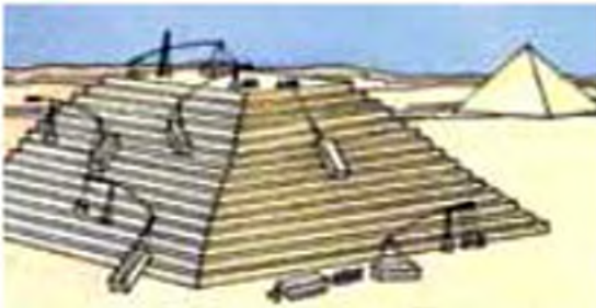
Рис. 209. Використання важелів при спорудженні давньоєгипетських пірамід
