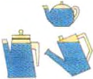
Рис. 163. Прояви принципу сполучених посудин при різних положеннях чайника
