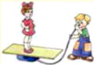
Рис. 147. Піднімання людини за допомогою гумової камери з трубкою, в яку вдувають повітря
