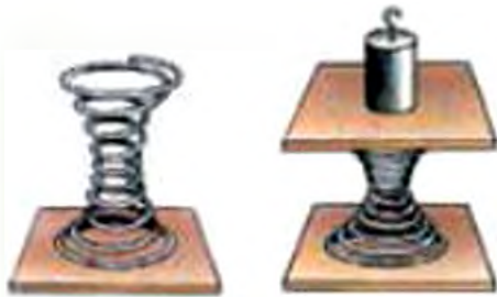
Рис. 111. Дослід з деформацією пружини: а) пружина у недеформованому стані; б) деформація пружини під дією гири
