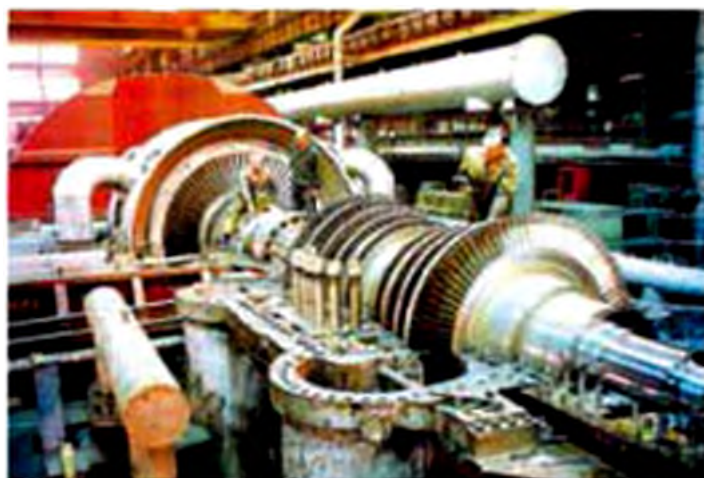
Рис. 226. Монтаж турбіни на заводі «Турбоатом» (м. Харків)
