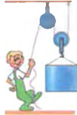
Рис. 220. Система нерухомого і рухомого блоків
