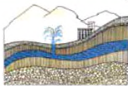
Рис. 164. Системи артезіанського колодязя
