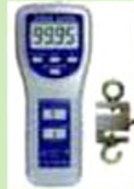
Рис. 120. Сучасний електронний динамометр
