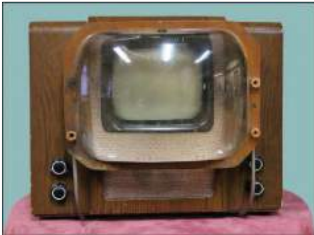
Телевізор «4ВН» з збільшувальною сіткою (початок 1950-х рр.)
