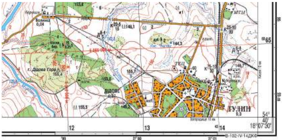
Мал. 8. Визначення прямокутних координат на топографічних картах
