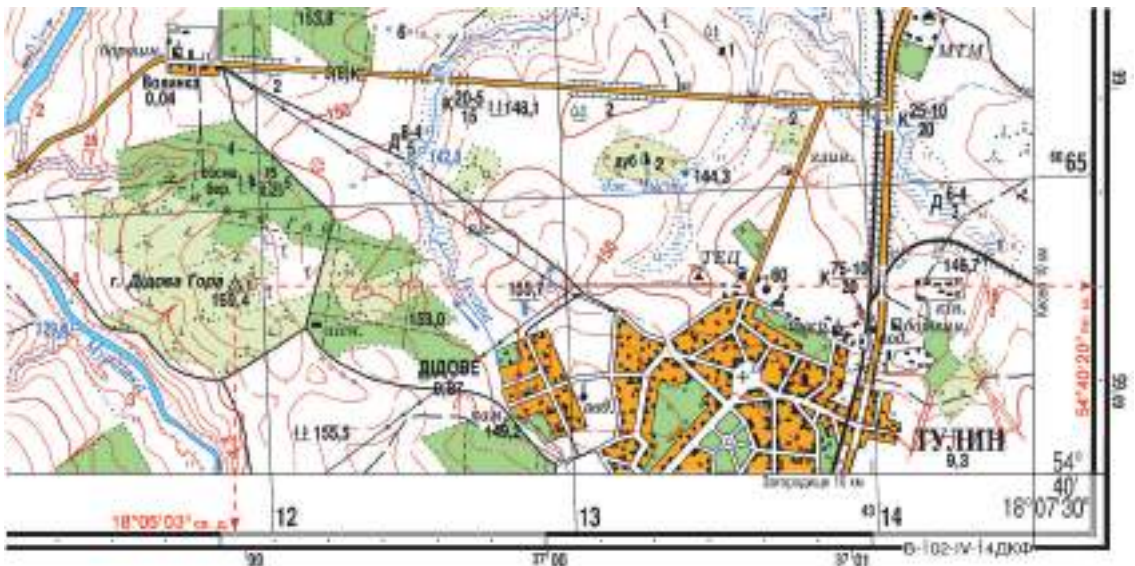
Мал. 6. Визначення географічних координат за рамкою топографічної карти
