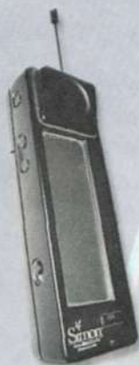
1993 рік Перший комунікатор Розробник: IBM і Bell South Модель: IBM Simon Personal Communicator
