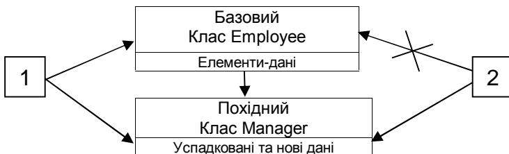
Рис. 2.2. Показчик на базовий клас (1) та показчик на похідний клас (2)
