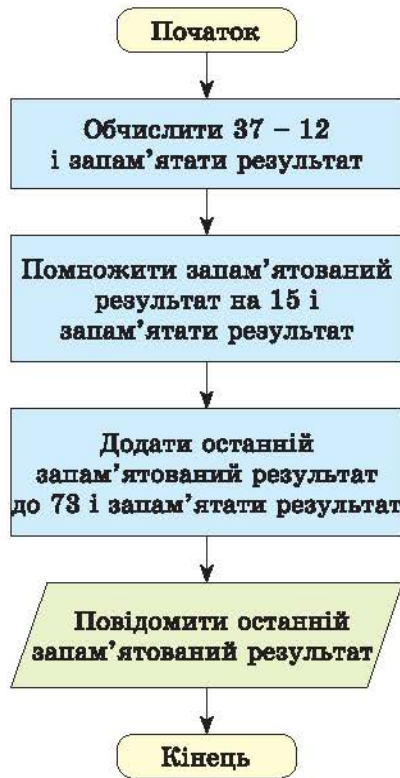
Рис. 1.20. Блок-схема алгоритму обчислення значення виразу 73 + (37 - 12) \cdot 15
