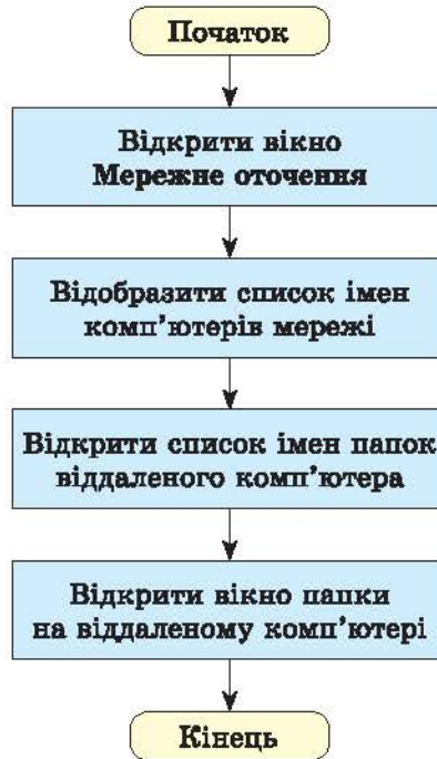
Рис. 5.8. Блок-схема алгоритму здійснення навігації локальною мережею
