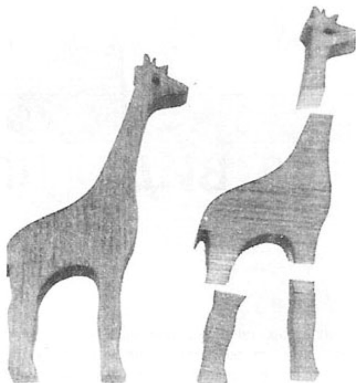
Ил. 4—2. Дерево прочно «в длину». Его намного сложнее сломать поперек длины и волокон, чем параллельно ей. Следовательно, изделие слева более крепкое, чем изделие справа. Даже несмотря на то, что оба были изготовлены из одной доски
