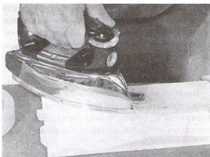
Ил. 7—18. Трафареты, полученные с помощью офисной копировальной техники, могут быть перенесены на заготовку с помощью утюга. Изображение получится «перевернутым» (см. ил. 7—19).
