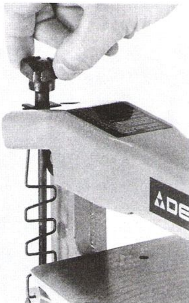
Ил. 6—11. На большинстве моделей пил регулятор натяжения полотна установлен на передней части верхней рамы. Вращение по часовой стрелке усиливает натяжение, а против — ослабляет
