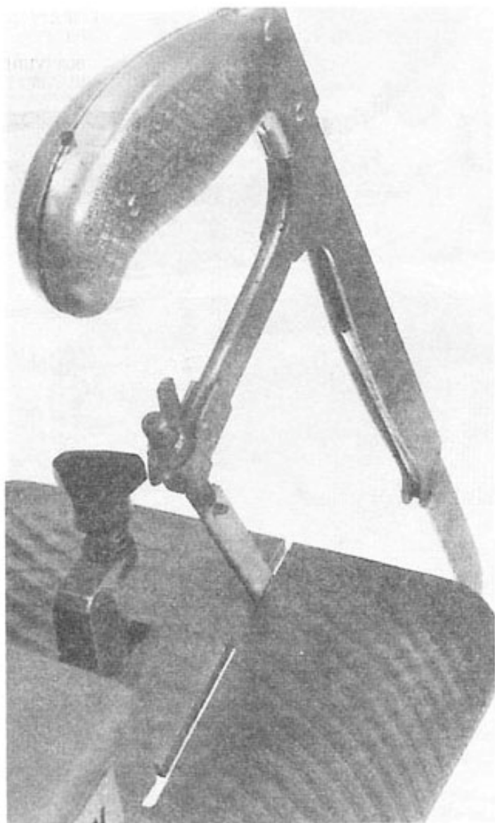
Ил. 3—9. Процесс увеличения отверстия рабочего стола показан крупным планом. С помощью трех полотен ножовки, закрепленных вместе, можно получить разрез желаемой ширины. Мягкий чугун пилится особенно легко
