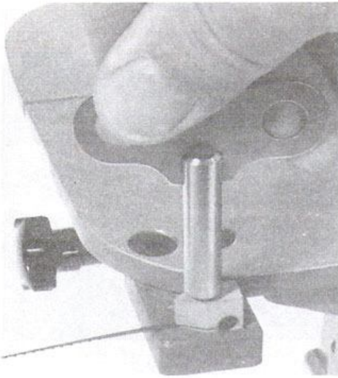
Ил. 6—2. Приспособление для смены полотна в пиле марки «Хегнер» установлено на рабочем столе. Оно надежно фиксирует зажим полотна во время закрепления в нем полотна
