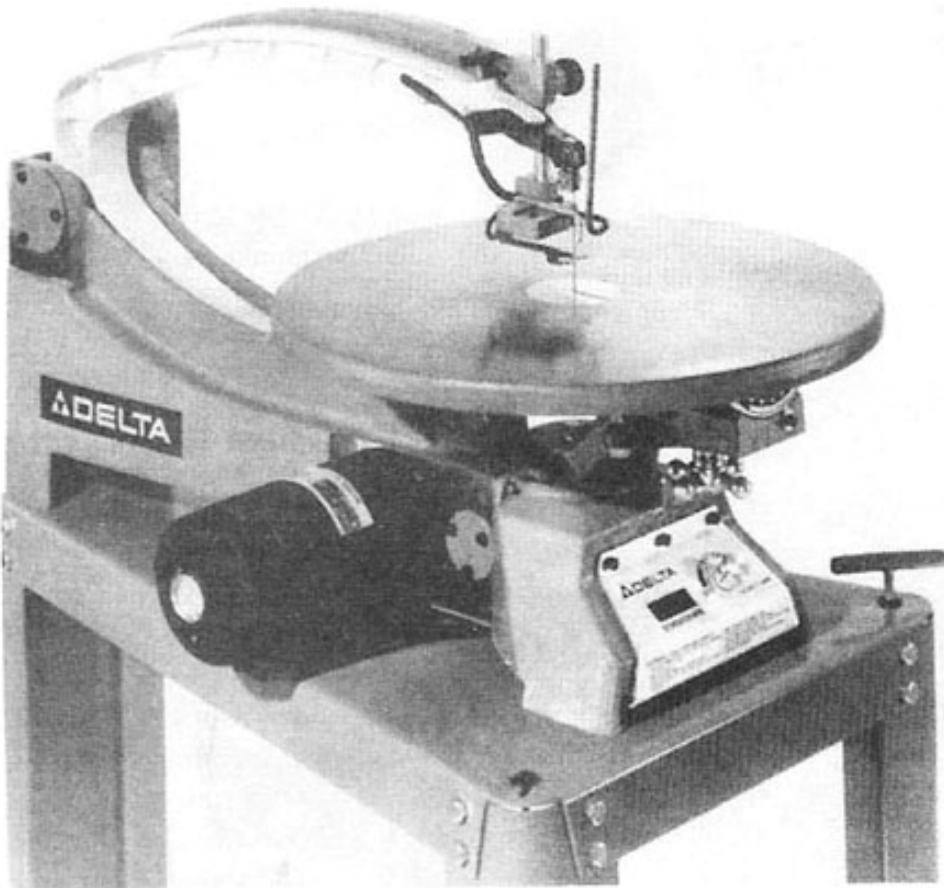
Ил. 1—10. 18-дюймовая модель «Дельта» с «С»-образной рамой. Скорость режущего полотна от 40 до 2000 ходов в минуту
