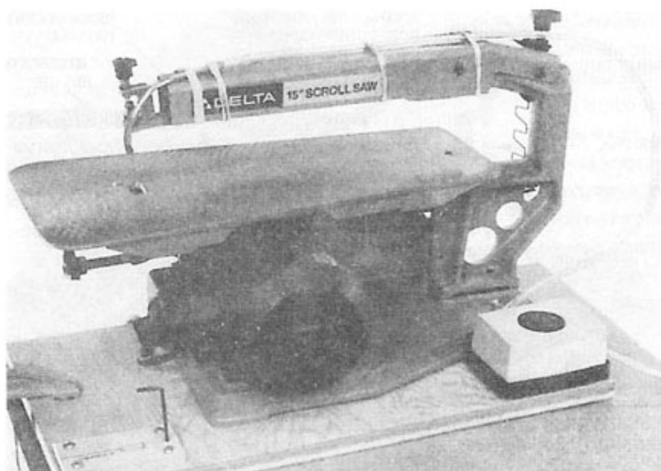
Ил. 3—4. Небольшая аквариумная помпа может быть использована как воздуходувное устройство к этой 15-дюймовой пиле
