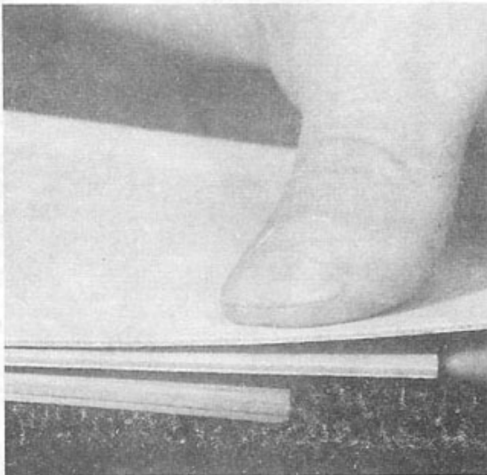
Ил. 4—6. Фанера производится как из мягких, так и из твердых пород древесины. Толщина фанеры — от \frac{1}{32} до \frac{3}{4} дюйма. Наиболее часто используемыми размерами являются: \frac{1}{4} , \frac{3}{8} , \frac{1}{2} и \frac{3}{4} дюйма.
