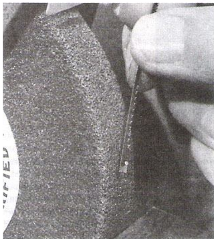
Ил. 9—12. Шлифование штифта, закрепленного на окончании режущего полотна
