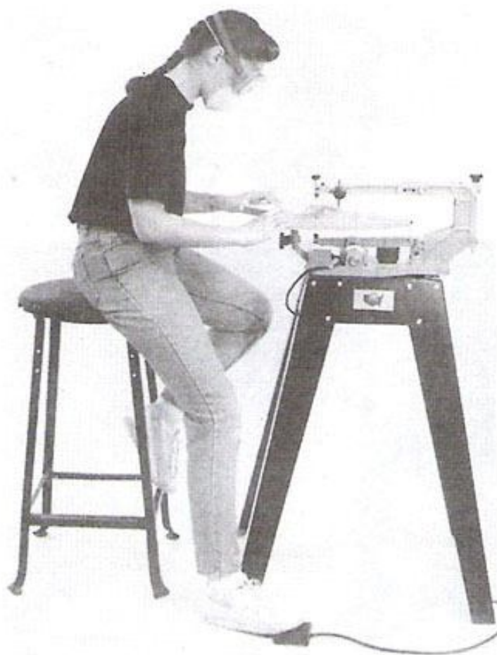
Ил. 5—1. Эта женщина работает в соответствии с требованиями правил техники безопасности. На ней нет свободной одежды и болтающихся ювелирных украшений, ее волосы собраны сзади и надеты защитные очки и респиратор. Также обратите внимание, что высота стула позволяет ей сидеть с прямой спиной, она использует ножной переключатель, зажим для заготовки. Рабочее место хорошо освещено
