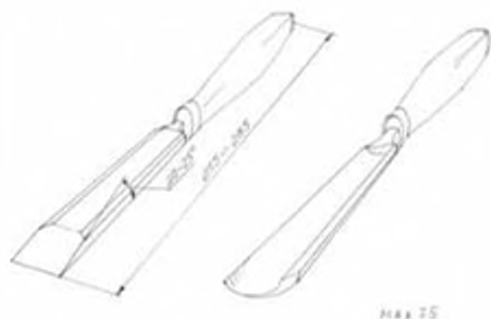
Мал. 75. Інструмент для різання деревини: а — плоска стамеска; б — півкругла стамеска
