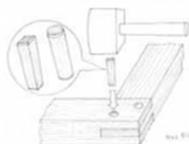
Мал. 84. Закріплення шипового з'єднання
