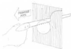
Мал. 56. Напрямок робочого руху під час пиляння викружною пилою
