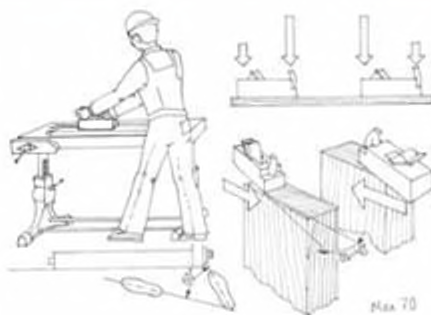
Мал. 70. Техніка стругання ручним інструментом:
