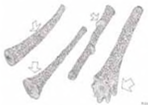
Мал. 29. Ваді форми стовбура: а — кривизна; б — збіг; в — нарости; г — окоренкуватість
