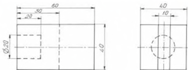
Мал. 32 Зовнішній вигляд об'ємної деталі, показаний на площині креслення
