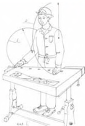
Мал. 6. Загальний вигляд робочого місця у столярній майстерні та зони досяжності в горизонтальній площині
