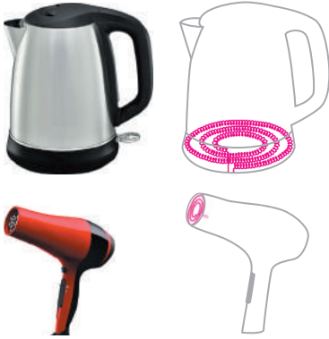
Рис. 3.3. Основна частина будь-якого нагрівального пристрою — нагрівальний елемент, який являє собою виготовлений із тугоплавкого матеріалу з великим питомим опором провідник, що має невелику (порівняно з підвідними проводами) площу поперечного перерізу
