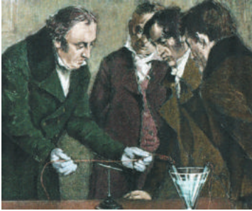
Рис. 10.1. Дослід Ерстеда: поблизу провідника зі струмом магнітна стрілка відхиляється від напрямку «північ — південь», намагаючись розташуватися перпендикулярно до провідника
