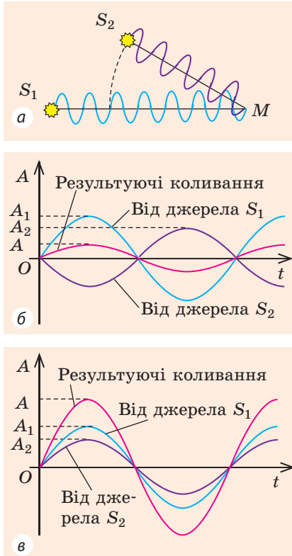
Рис. 22.6. Якщо хвилі надійшли в точку M у протилежних фазах, амплітуда результуючих коливань зменшується: A = A_1 - A_2 (б), а якщо в однаковій фазі, амплітуда результуючих коливань збільшується: A = A_1 + A_2 (в)
