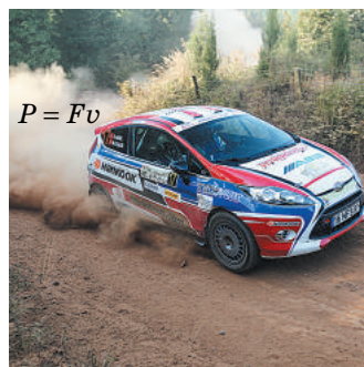
Рис. 15.3. Коли для руху автомобіля потрібна більша сила тяги, водій переходить на меншу швидкість або натискає на газ, збільшуючи таким чином потужність двигуна
