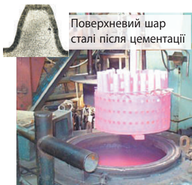
Рис. 27.4. Процес насичення поверхневого шару сталі вуглецем називають цементацією . Якщо виготовити деталь із низьковуглецевої сталі, а потім помістити її у високотемпературну суміш, яка містить вуглець, то завдяки дифузії поверхневий шар сталі збагатиться вуглецем. Отримана деталь одночасно буде твердою (зовні — міцний чавун) і не буде руйнуватися внаслідок ударних навантажень (усередині — пружна сталь)
