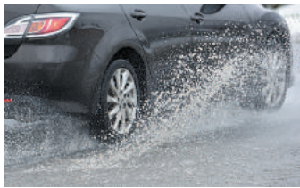
Рис. 8.2. Швидкості руху іскор феєрверка, бризок з-під коліс автомобіля, металевих ошукорк напрямлені по дотичній до кола. Саме в цьому напрямку частинки продовжують свій рух після відриву
