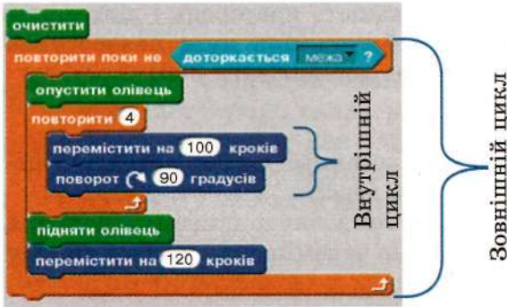
Мал. 3.17. Вкладені цикли з використанням циклів з передумовою в Scratch
