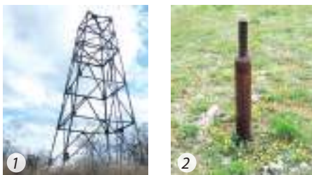
Мал. 20. Опорний пункт державної геодезичної мережі (1). Репер – знак абсолютної висоти точки (2)
